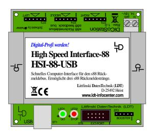
Überträgt die Rückmeldeinformationen vom s88 Bus ohne den Umweg über die Digitalzentrale direkt zum PC. Schnelle, galvanisch getrennte Verbindung zum Computer über die USB-Schnittstelle (1.1 / 2.0 Full-Speed).
